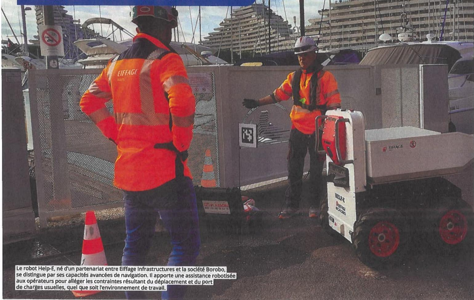
Le robot Help-E, né d'un partenariat entre Eiffage Infrastructures et la société Borobo, se distingue par ses capacités avancées de navigation. Il apporte une assistance robotisée aux opérateurs pour alléger les contraintes résultant du déplacement et du port de charges usuelles, quel que soit l'environnement de travail.
